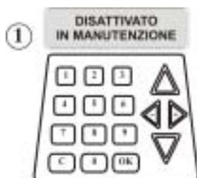
ACCENDERE IL QUADRO STRUMENTI E ATTENDERE FINO A QUANDO VERRA' VISUALIZZATO SUL DISPLAY - TVM 5.2 OK IN MANUTENZIONE -
