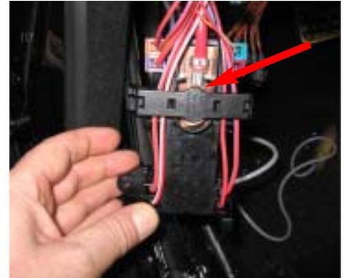
**COLLEGAMENTO DA ESEGUIRE SOLO PER IL KIT Cat. Q4 54 3701****+15****Collegamento POSITIVO SOTTO QUADRO +15/54**
